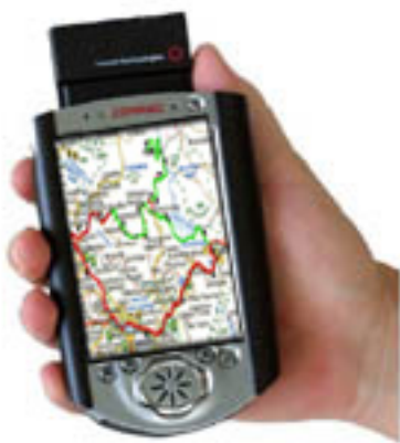
Σχήμα 1 - Τυπική διάταξη PDA και GPS, με κινητό GIS.
